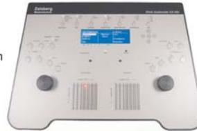
...auch als stand-alone Gerät mit Auflage für Audiogrammformulare. Selbsterständlich mit bidirektionaler PC Schnittstelle!
